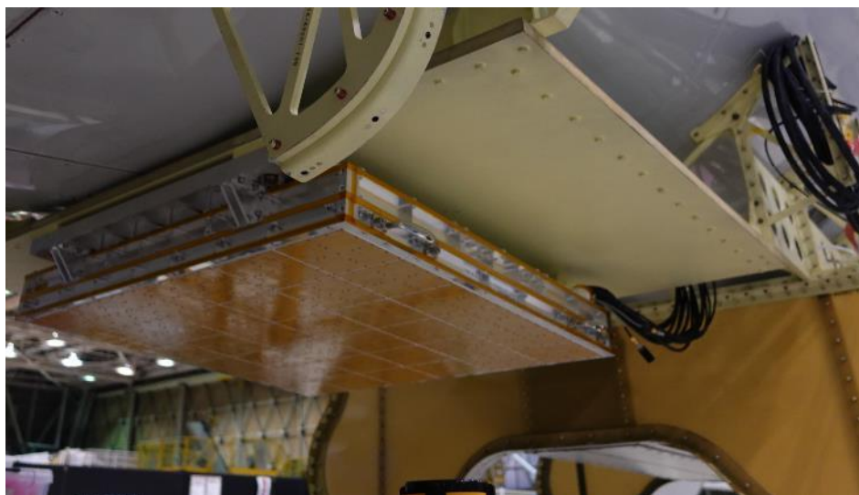
試験装置(無線電力伝送装置) レドーム内に取り付け済み
